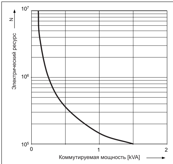
Электрический ресурс по функции мощности нагрузки. Неиндуктивная цепь. Максимальная частота коммутации при номинальной нагрузке. Диаг. 1
