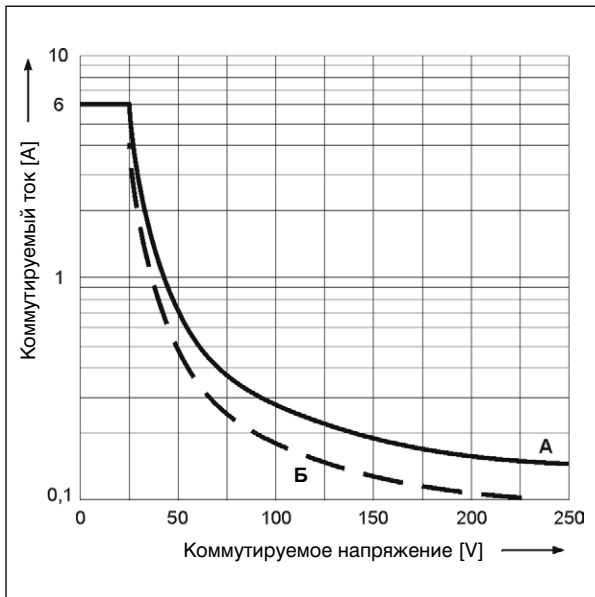
Макс. способность коммутации для постоянного тока: А - резистивная нагрузка DC1 Диаг. 3 Б - индуктивная нагрузка L/R = 40 мсек.
